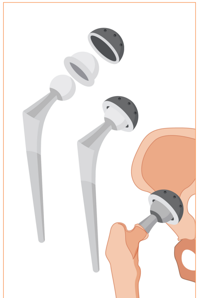
Figura 4. Componentes de una prótesis de cadera.
